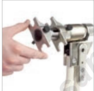
4. Замену запрессовочных насадок следует производить, когда инструмент находится в исходном положении (рукойтки инструмента полностью разведены).
