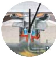
Спустя 4 минуты, ок. 460 °C: пластиковая труба становится пластичной.
