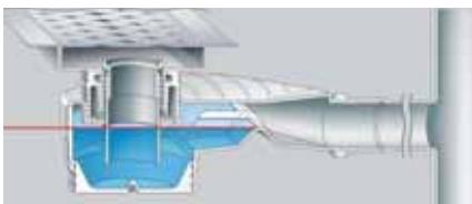
В нормальном рабочем состоянии уровень воды гидравлического затвора составляет 35, 40 или 50 мм.
