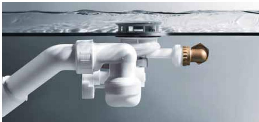
Компактная конструктивная высота – всего 110 мм. Эта арматура с превосходным дизайном может быть использована для любых ванн с толщиной стенки от 3 до 10 мм и сливным отверстием 52 мм или 90 мм. Накладка изготовлена из хромированной латуни.
