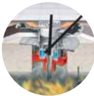
Спустя 8 минут, ок. 625 °C: труба расплавлена, разбухшая масса заполняет все кольцевое отверстие.
