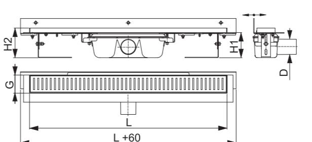
Ширина душевой кабины (мм)      Длина водоотводящего желоба/решетки L (мм)
