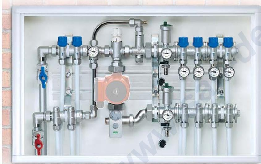
Il collettore con i detentori è dotato di vitoni micrometrici che facilitano la taratura di ogni circuito. Sul collettore valvola è invece possibile, togliendo il volantino installare il comando elettrico. Sono disponibili teste elettriche 24V o 230V con e senza microinterruttore, normalmente aperte o normalmente chiuse a seconda della versione.
