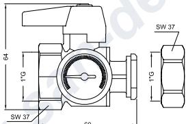
**ТИП: V-6080** Оконечник коллектора (пара) 1" с накидной гайкой и прокладкой, воздушником 3/8"
