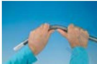
Изгиб при помощи внутренней спиральной пружины
