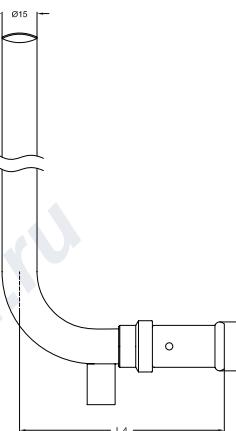
**ТИП: 39Р** Нижнее подключение к радиаторам, закрытое, никелированная медная труба, Ø 15, 300мм
