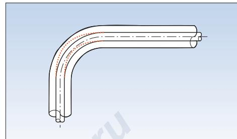
Предпочтительно всегда устанавливать трубы в защитном кожухе (гофрированной трубке) или лучше в изоляции.
