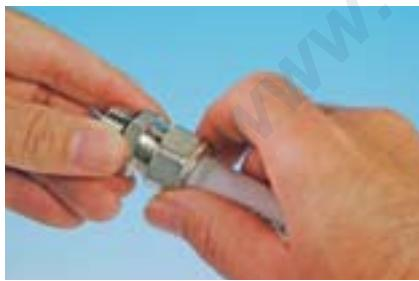
Теперь заверните гайку на ниппеле, метчике, или коллекторе до достижения усилия, рекомендованного производителем.
