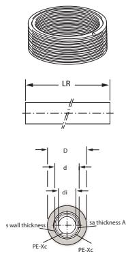
**Труба в бухте: изоляция 6 мм**
