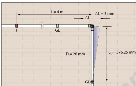
Для трубы с диаметром 26 мм и длине 4, которая имеет изменение направления с перепадом температур  $50^\circ\text{C}$  необходимо поставить компенсатор 376,25 мм, для распределения изменений по длине.
