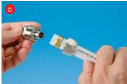
Вставьте переходник или муфту в трубу и протолкните их до упора. Убедитесь, что синтетическое кольцо, предотвращающее электролиз, присутствует. Чтобы облегчить процесс скольжения Вы можете смазать гайку силиконовым маслом. Не используйте минеральное масло!
