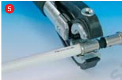
Откройте пресс клещи и убедитесь, что манжета фитинга находится в канавке клещей. Чтобы обеспечивать правильное сжатие, работайте с инструментом до тех пор пока обжимные насадки будут выполнять запрессовку автоматически.
