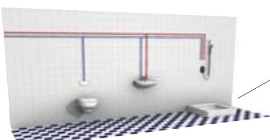
Подача холодной и горячей воды ко всем изделиям сантехнического оборудования производится по одной трубе. Отводы выполнены с использованием переходных тройников.
