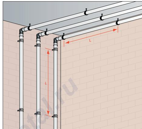
Хомуты для труб имеют двойное назначение, первое – они поддерживают трубопровод, и второе – они воспринимают тепловые изменения длины трубы в подвижных и фиксированных точках обычно в комбинации с правильно рассчитанными компенсаторами и углами. В подвижных опорах должен быть обеспечен постоянный зазор между трубой и креплением. При расширении трубы подвижные опоры не могут становиться неподвижными.
