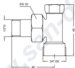
ТИП: RADV-2-R Вентиль на обратную подводку 1/2", прямой, никелированный, соединение евроконус 3/4"
