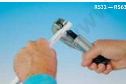
Производите калибровку трубу калибратором Henco Kalispeed. Вставьте калибровочное устройство правильно в трубу поверните таким образом, чтобы образовалась равномерная фаска с внутреннего и внешнего края трубы. Удалите все отходы
