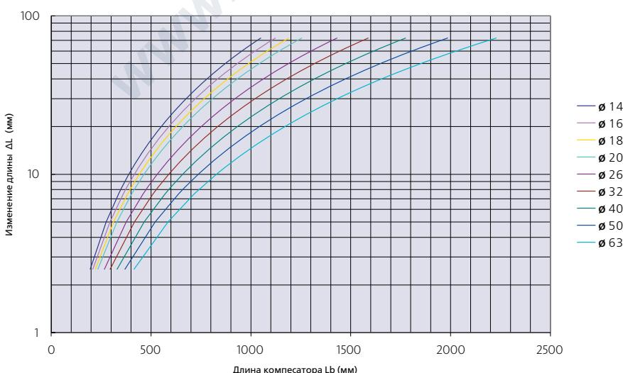
Необходимо обеспечить свободный ход трубы, когда трубная система идет от пола к подающей трубе через короб. Здесь также изменения по длине распределяются при помощи компенсатора расширения. Компенсатор должен компенсировать движения вверх и вниз.
