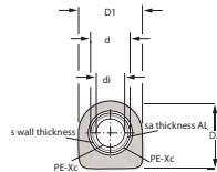
**Труба в изоляции (ассиметричного сечения) в бухте:
