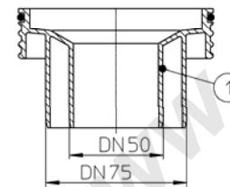
1. Вентиляционный клапан можно устанавливать в жилых помещениях (в санузлах), так как мембрана гарантированно запирает загрязненный воздух в канализационных трубопроводах.
