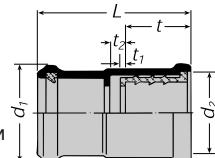
Все компенсационные муфты поставляются с установленными уплотнительными втулками и уплотнительными кольцами.
