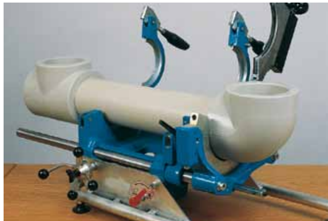
готовое сварное соединение после охлаждения
