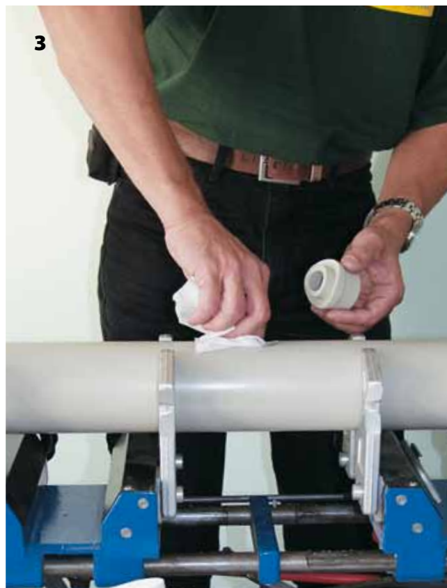
3 Вварное седло надеть на насадку так, чтобы были совмещены метки на седле и насадке. Прогреть отверстие и ввариваемое седло. Время прогрева как у трубы диаметром 32 мм – 8 с. Для сварных седел 110 x 32 и 110 x 40 время нагрева такое же, как для диаметра 40 мм – 12 сек.
