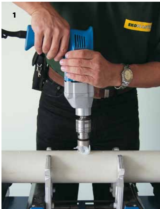
1 Специальной фрезой высверлить отверстие для седла
