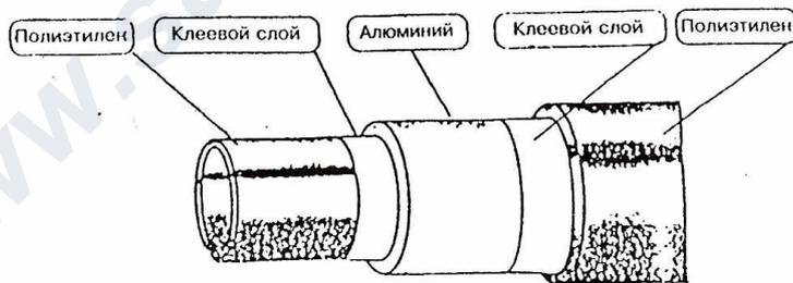
Рисунок 1 — Структура металлополимерной трубы
