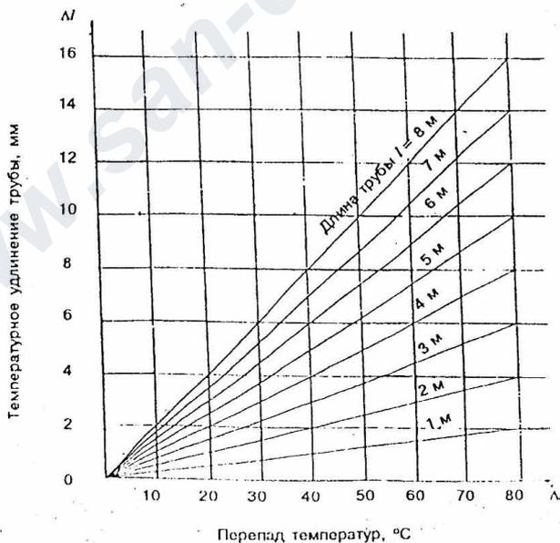
Рисунок 10 — Диаграмма для определения удлинения труб
